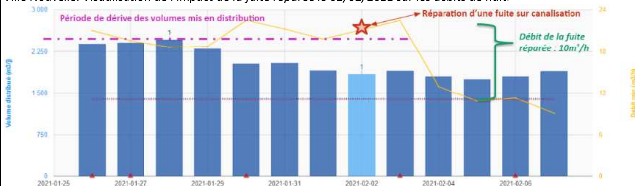
Graphique 2 : Evolution des volumes journaliers mis en distribution et des débits de nuit sur le secteur Jouy le Moutier Ville Nouvelle. Visualisation de l'impact de la fuite réparée le 15/07/2021 sur les débits de nuit.
