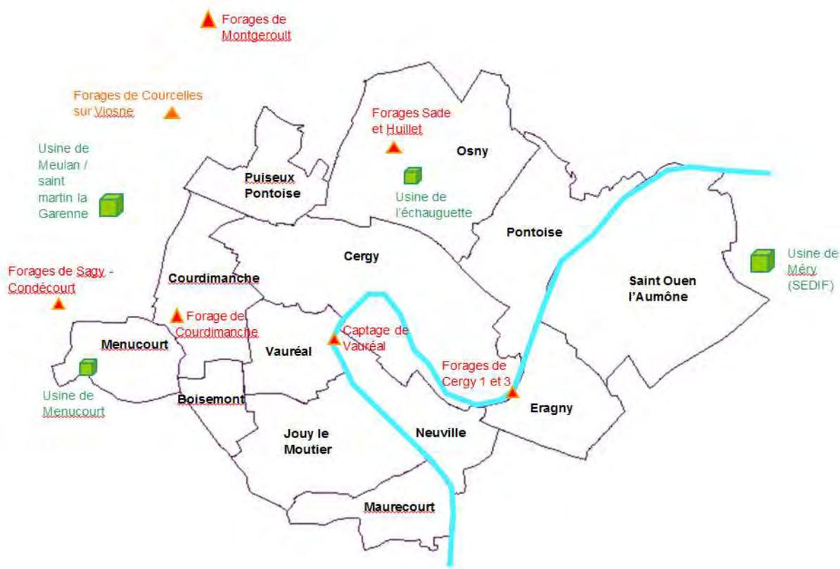
Selon les points de production, les eaux subissent, avant distribution, des traitements de déferrisation, dénitrification, ou des mélanges. Un traitement de désinfection (chloration) est également effectué.
