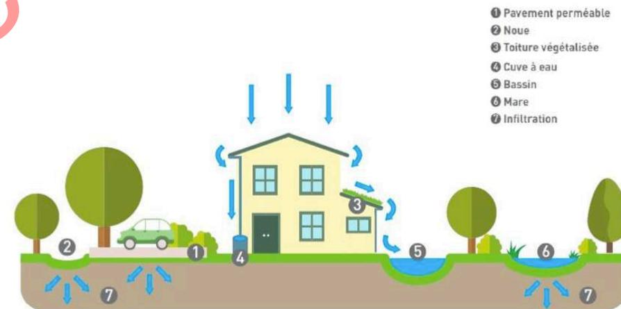
Figure 19: Aménagement pour la gestion des eaux pluviales à la parcelle : exemple 1
